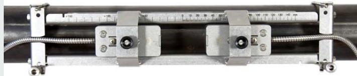
Medición con transductores montados mediante Variofix portátil VP
