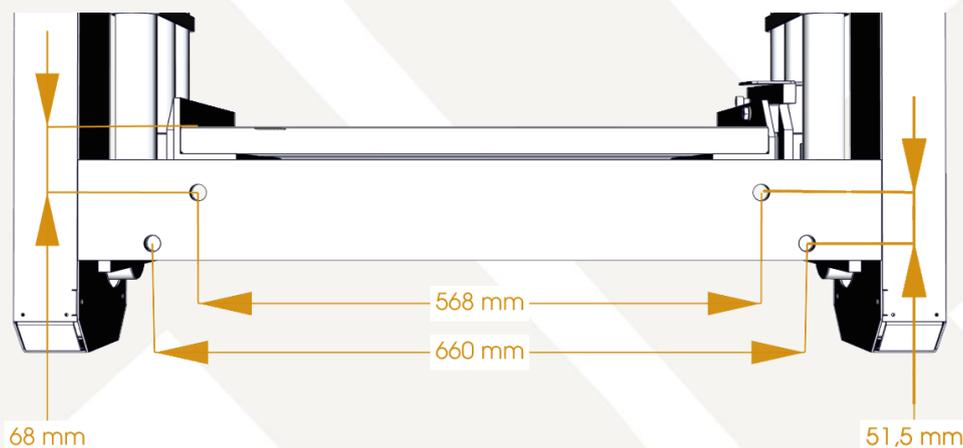
Figura 1 – Medidas de Furação de Fixação da Escada
